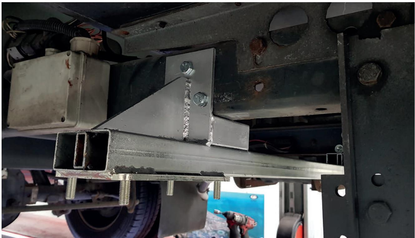
Placez l'adaptateur derrière l'essieu arrière. Ne percez les trous que lorsque l'adaptateur est complètement inséré. Dans certains cas, il est possible d'utiliser des trous déjà présents sur le châssis.
