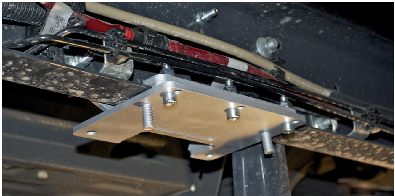
Die Dichtungsplatte in das Loch des Rahmens einführen, den Adapter einsetzen und nach vorne schieben, dann die Schelle auf der Innenseite des Rahmens montieren.
