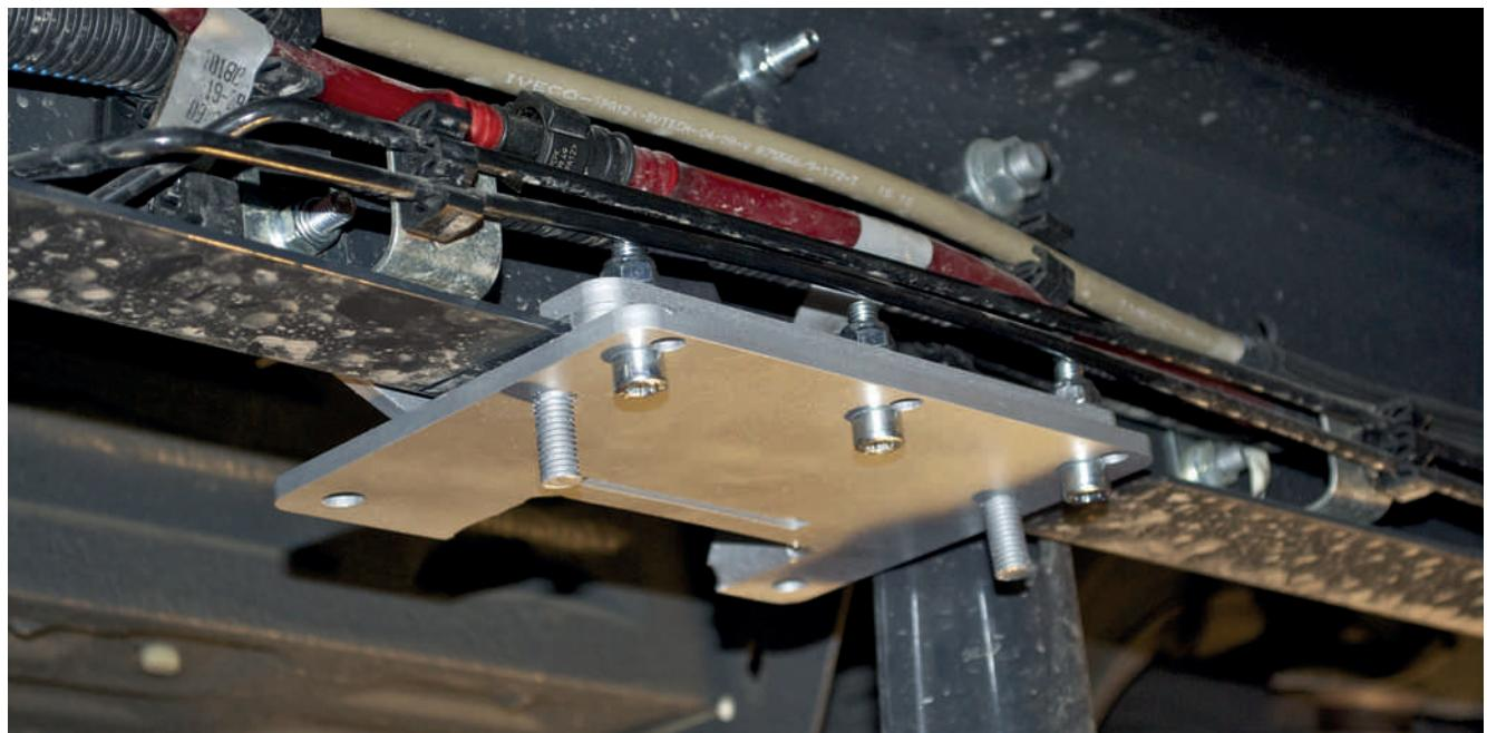
Sätt in tätningsplattan i hålet på ramen, placera adaptern och tryck den framåt, montera sedan klämman på insidan av ramen.
