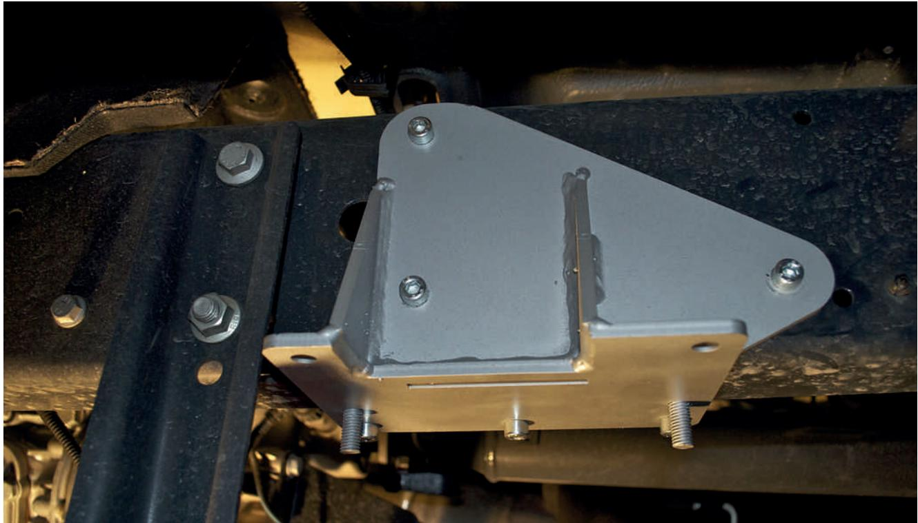
El adaptador debe colocarse justo detrás de la cuna de la caja de cambios y fijarse con tres tornillos M8, sin perforar ningún agujero en el bastidor, si éste es del último modelo (negro); en caso contrario, perforar tres agujeros.
