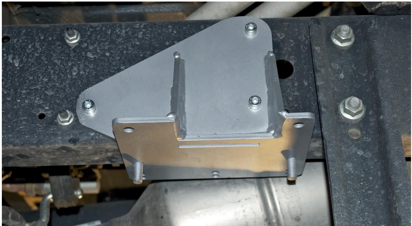
De adapter moet net achter de houder van de versnellingsbak worden geplaatst, volg dezelfde procedure als voor de adapter linksvoor.
