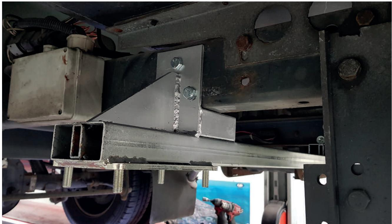
Placera adapttern bakom bakaxeln. Borra hålen först när adapttern är helt insatt. I vissa fall är det möjligt att använda hål som redan finns på chassit.
