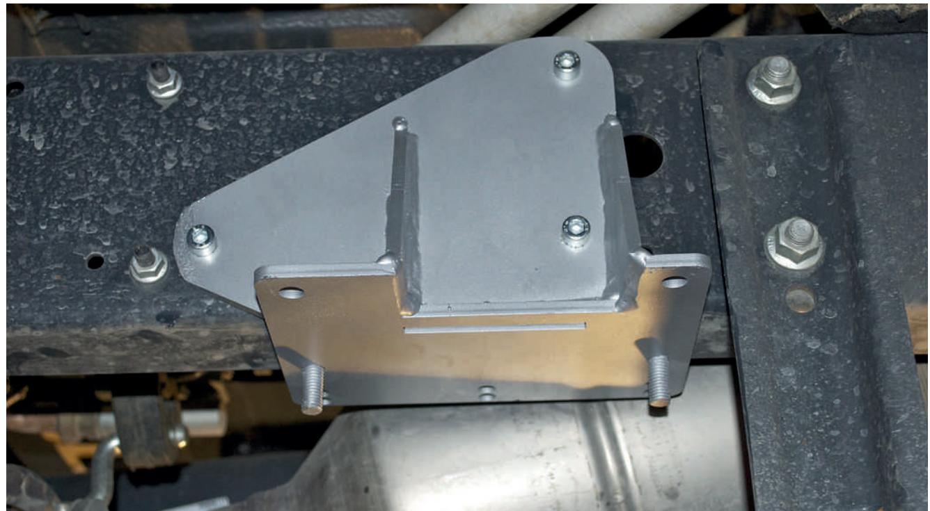
L'adaptateur doit être placé juste derrière le berceau de la boîte de vitesses, suivez la même procédure que pour l'adaptateur avant gauche.
