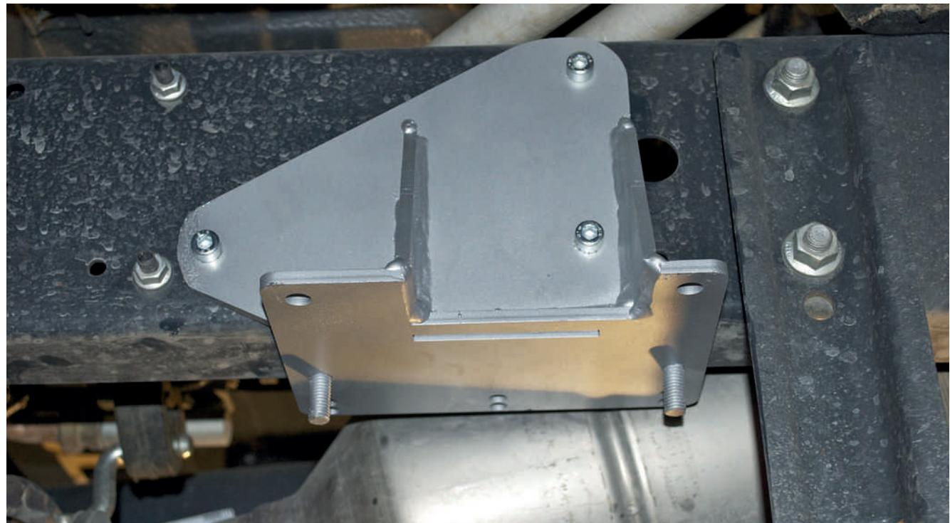
El adaptador debe colocarse justo detrás de la cuna de la caja de cambios, siga el mismo procedimiento que para el adaptador delantero izquierdo.
