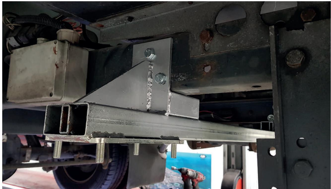
Plaats de adapter achter de achters. Boor de gaten pas nadat de adapter volledig is ingebracht. In sommige gevallen is het mogelijk gaten te gebruiken die reeds op het chassis aanwezig zijn.
