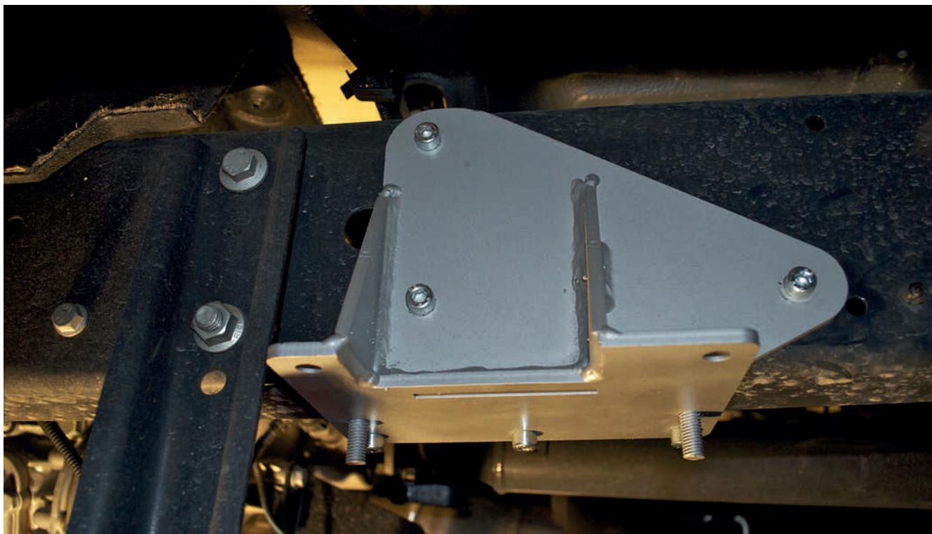
Adapteren skal placeres lige bag gearkassevognen og fastgøres med tre M8-skruer uden at bore nogen huller i rammen, hvis rammen er af den nyeste model (sort); ellers bores der tre huller.
