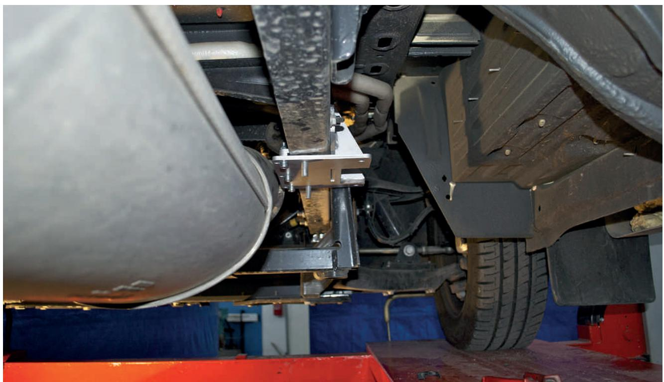
Asenna tunkki paikalleen (noudata käyttöohjetta säätöjen osalta).
