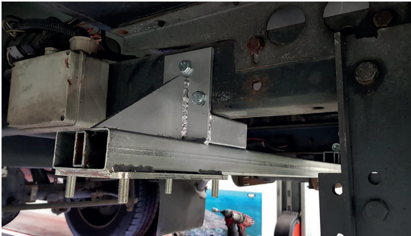
Colocar el adaptador detrás del eje trasero. Perforar los agujeros sólo después de que el adaptador esté completamente insertado. En algunos casos es posible utilizar los agujeros ya presentes en el chasis.
