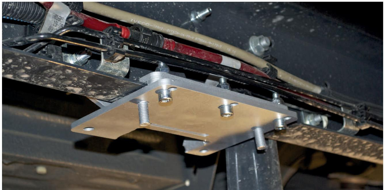
Steek de afdichtplaat in het gat van het frame, plaats de adapter en duw deze naar voren. Montere vervolgens de klem aan de binnenkant van het frame.
