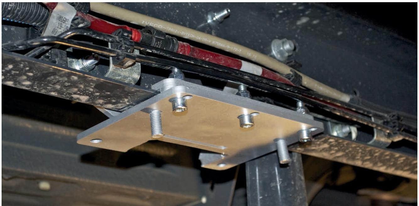
Insérez la plaque d'étanchéité dans le trou du cadre, placez l'adaptateur et poussez-le vers l'avant, puis montez la pince à l'intérieur du cadre.
