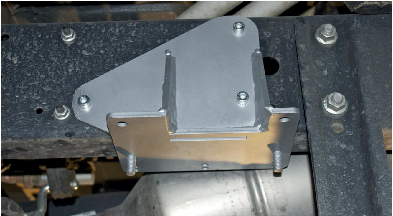
Der Adapter muss direkt hinter dem Getriebeträger angebracht werden, gehen Sie dabei genauso vor wie beim Adapter vorne links.
