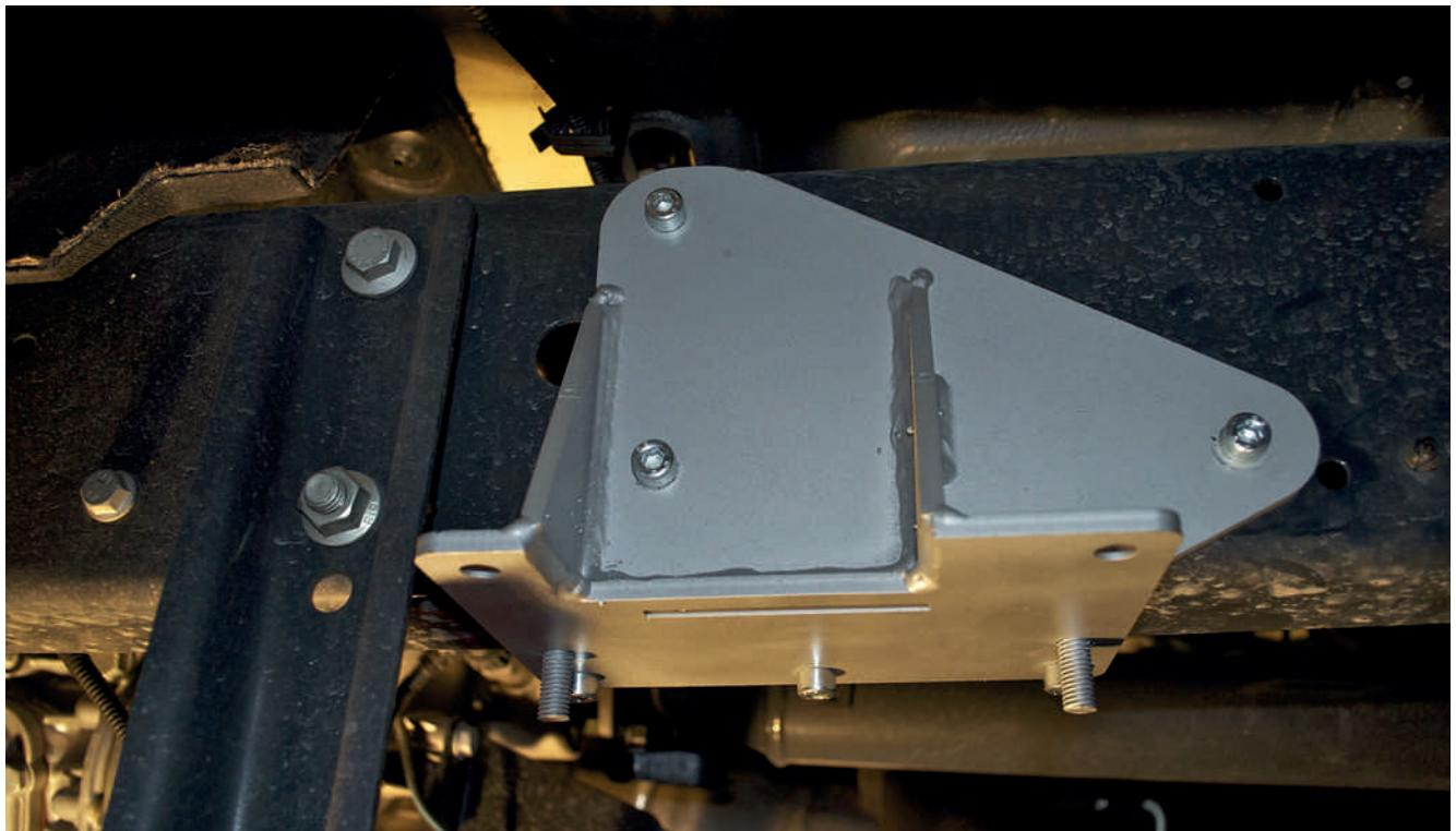
L'adaptateur doit être placé juste derrière le berceau de la boîte de vitesses et fixé à l'aide de trois vis M8, sans percer de trous sur le châssis, si le châssis est du dernier modèle (noir) ; sinon, percez trois trous.
