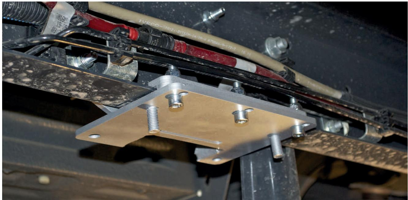
Inserire la piastra di tenuta nel foro del telaio, inserire l'adattatore e spingerlo verso la parte anteriore, quindi montare il morsetto sul lato interno del telaio.
