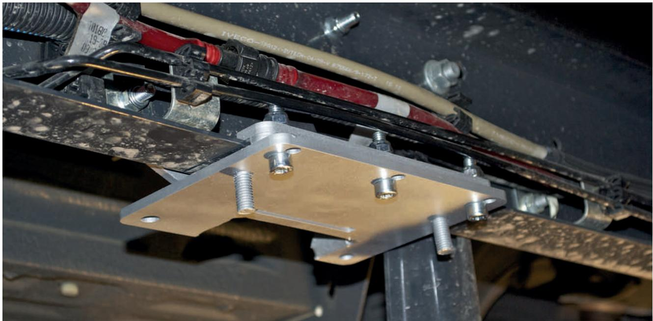
Inserte la placa de sellado en el agujero del bastidor, coloque el adaptador y empújelo hacia el frente, luego monte la abrazadera en el interior del bastidor.
