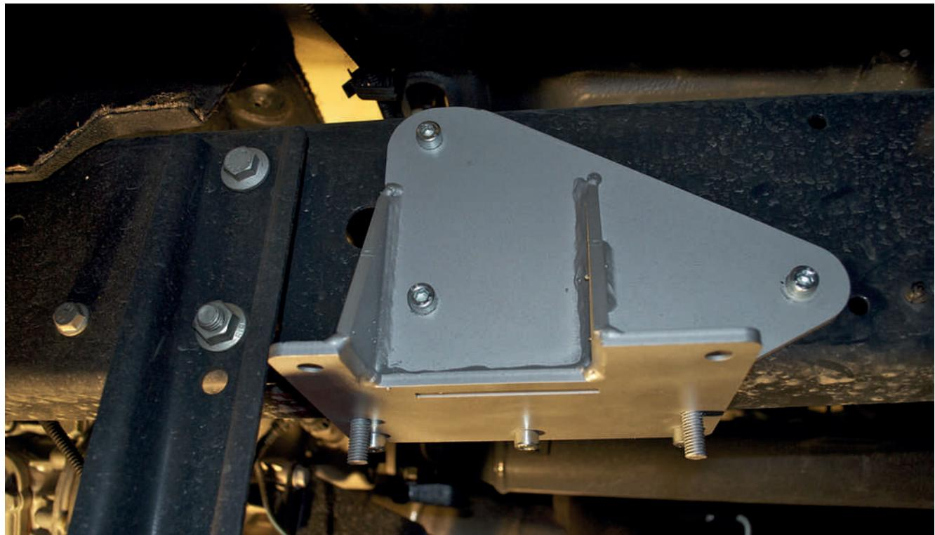
Sovitin on asetettava juuri vaihdelaatikon kehikon taakse ja kiinnitettävä kolmella M8-ruuvilla poraamatta runkoon reikiä, jos runko on uusinta mallia (musta); muussa tapauksessa poraa kolme reikää.
