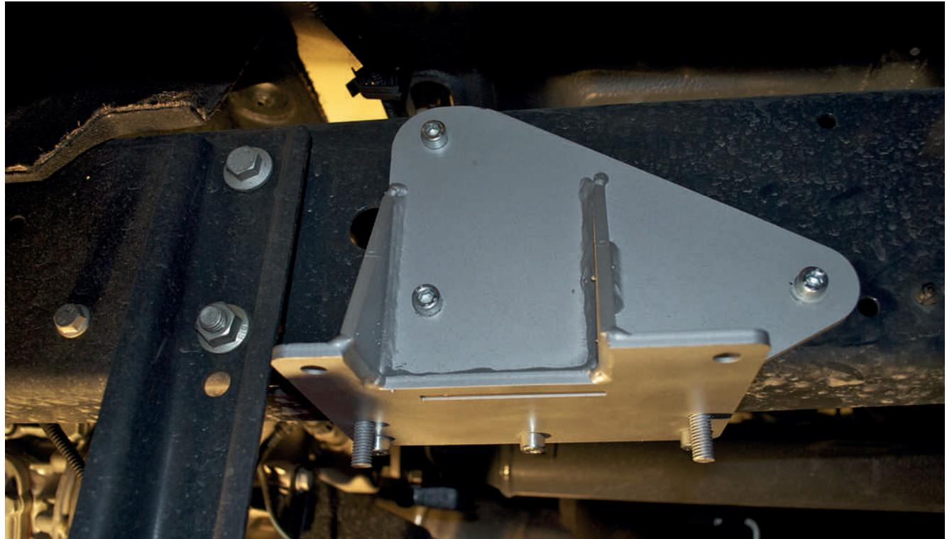
Adaptern ska placeras precis bakom växellådans vagga och fästas med tre M8-skruvar utan att borra några hål i ramen om ramen är av den senaste modellen (svart), annars borras tre hål.
