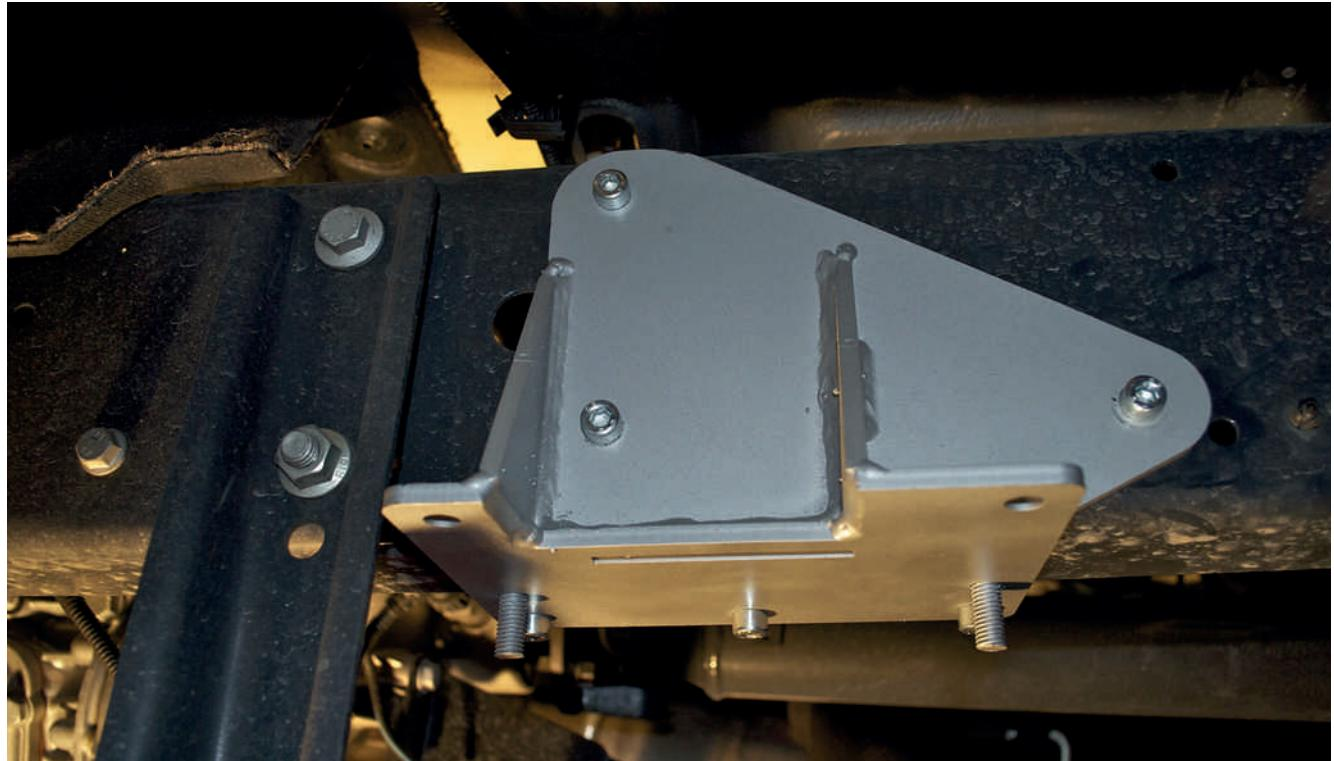
De adapter moet net achter de versnellingsbaksteun worden geplaatst en met drie M8-schroeven worden vastgezet, zonder gaten in het frame te boren, indien het frame van het laatste model is (zwart); anders boort u drie gaten.
