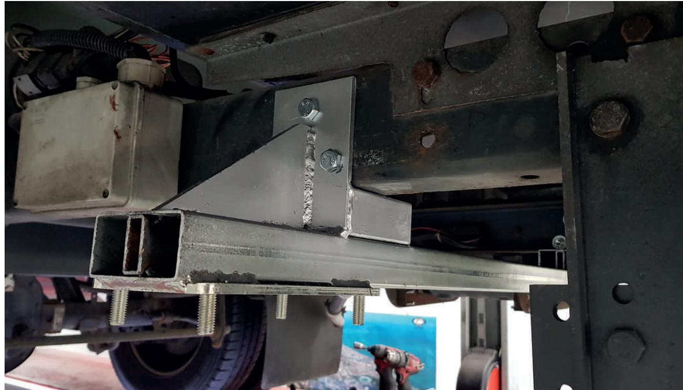
Bringen Sie den Adapter hinter der Hinterachse an. Bohren Sie die Löcher erst, wenn der Adapter vollständig eingesetzt ist. In einigen Fällen ist es möglich, bereits vorhandene Löcher am Fahrgestell zu verwenden.
